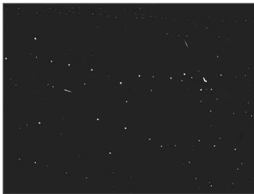
**Abb. 14** Reinraumtuch Hersteller 2, nach Wischen, Zeiss AxioZoom V16, 24fach (C & C-Forsch.-Labor)
