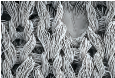
mehrlagiges thermobondiertes Polyester-Gestricke-Tuch (mit sichtbarem bonding-point), Hersteller codiert TEAS1U
