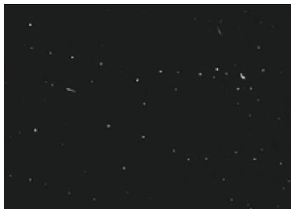
**Abb. 11** Reinraumtuch Hersteller 2, nach Wischen, Zeiss AxioZoom V16, 24fach
