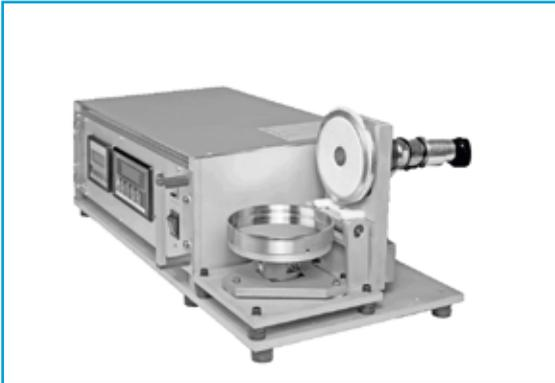
Abb. 42 Labuda Rotations-Wischsimulator Mark II zur Prüfung des Partikel-Abriebs
