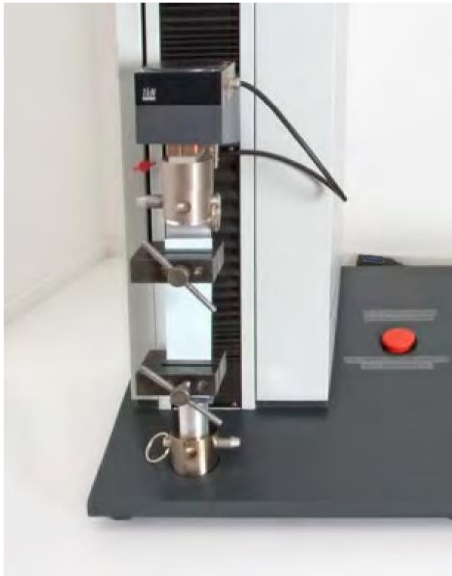
Abb. 1: Prüflings-Aufnahme der Zugprüf-Apparatur
