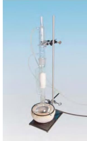
Abb. 1: Schema (links) und Aufbau (rechts) einer Soxhlet-Apparatur aus Laborglas
